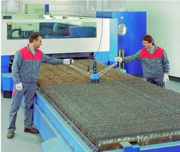
สามารถวางบนโต๊ะงานของเครื่องและทำความสะอาดได้โดยไม่ต้องหยุดเครื่อง และไม่เสียเวลาในการถอดย้าย slot ออกมา
