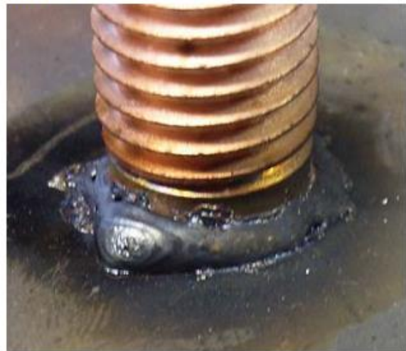
ลักษณะรอยเชื่อมรอบสตัดที่มีความสมบูรณ์ (complete collar formation)
